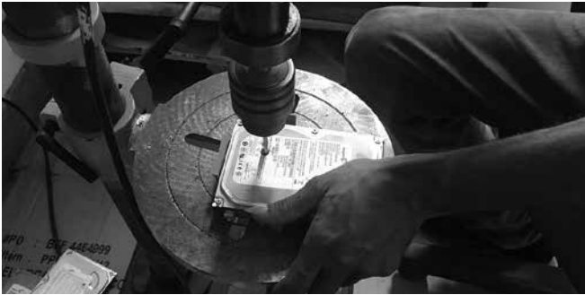
2020 ஜனவரியில் CEA பதிவுசெய்யப்பட்ட மின்னணு கழிவு மறுசுழற்சி சேவை வழங்குநரின் மூலம் அபாயகரமான மின்னணு கழிவுகளை மிக அதிக அளவில் அகற்றும் போது முக்கியமான தரவு பாதுகாப்பை உறுதி செய்வதற்காக ஒரு வன் தட்டு (hard disk) சேதமாக்கப்படுவதை படம் காட்டுகிறது.
